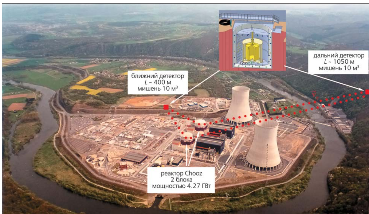
Рис.6. Схема эксперимента Double Chooz. Показаны реакторы и расположение ближнего и дальнего детекторов нейтрино. Ближний находится в стадии создания, и его запуск ожидается в 2013 г.
